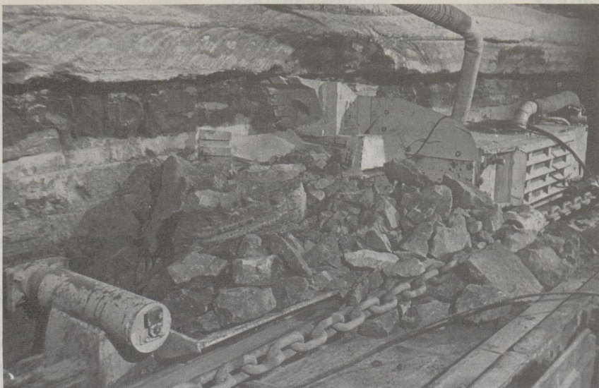
Рис. 6. Импульсный струг в экспериментальном забое шахты «Сомпа»
